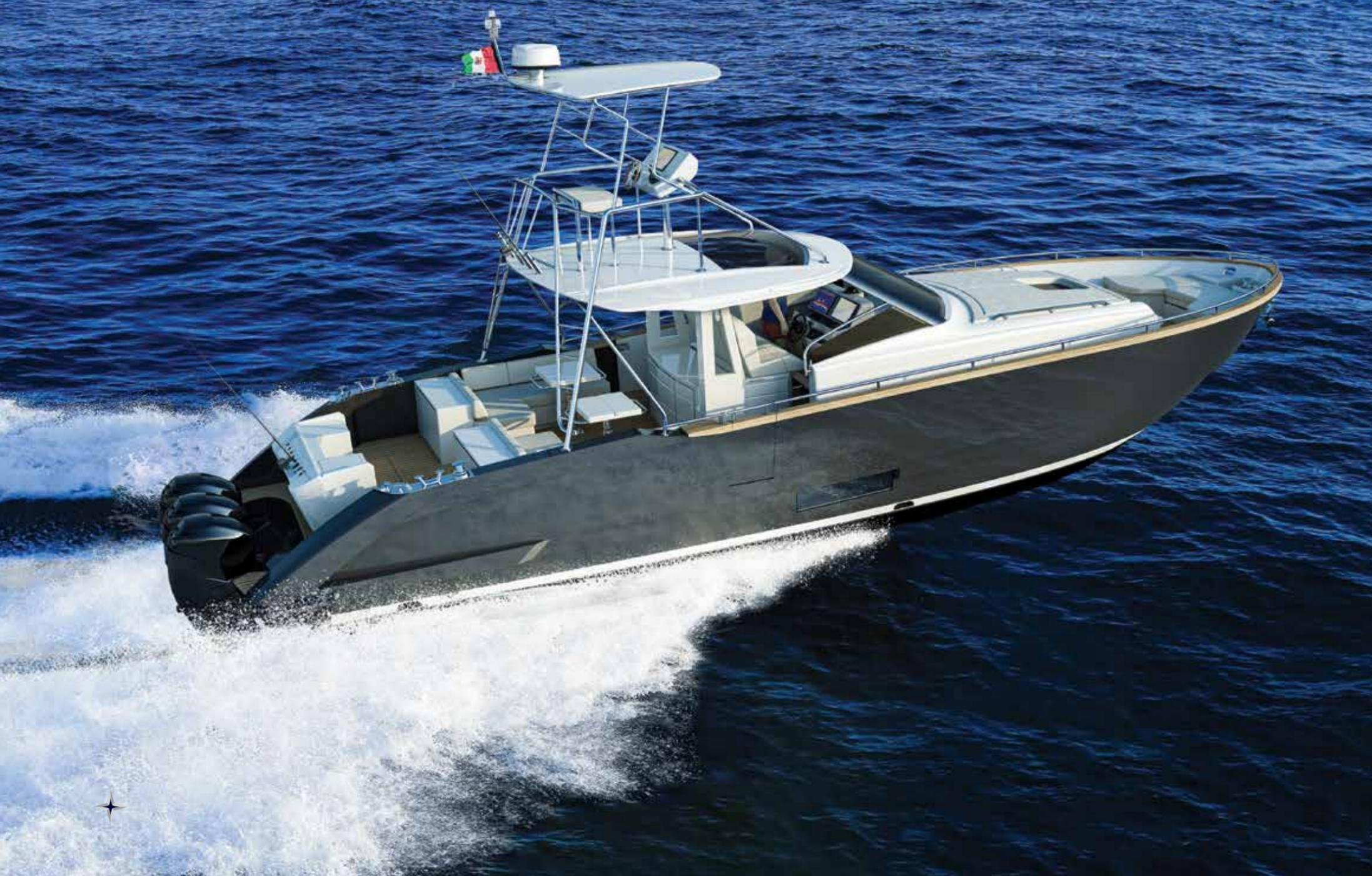
Il Cantiere ha progettato una versione specifica per gli amanti della pesca, con “tuna tower” (realizzata in struttura tubolare leggera), che ospita una seconda postazione di guida. A bordo, una serie di accessori come la vasca per il vivo, la ghiacciaia, la poltroncina da combattimento, porta-canne da azione e a riposo, completano le dotazioni specifiche.
